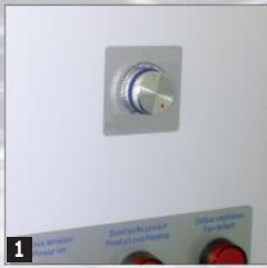
1 Fan speed controller
